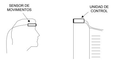
El producto IRdata 2000 funciona mediante una moderna tecnología de infrarrojo. Consta de una pequeña unidad que se coloca sobre el monitor y un sensor muy ligero (peso inferior a 35 gramos) que se fija, mediante una cinta, a un lado de la cabeza.
